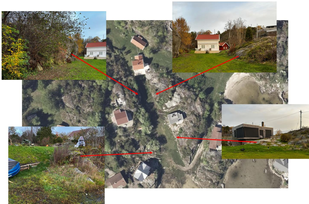
Figur 8: Bilder fra befaring og plassering av observerte berg i dagen.
