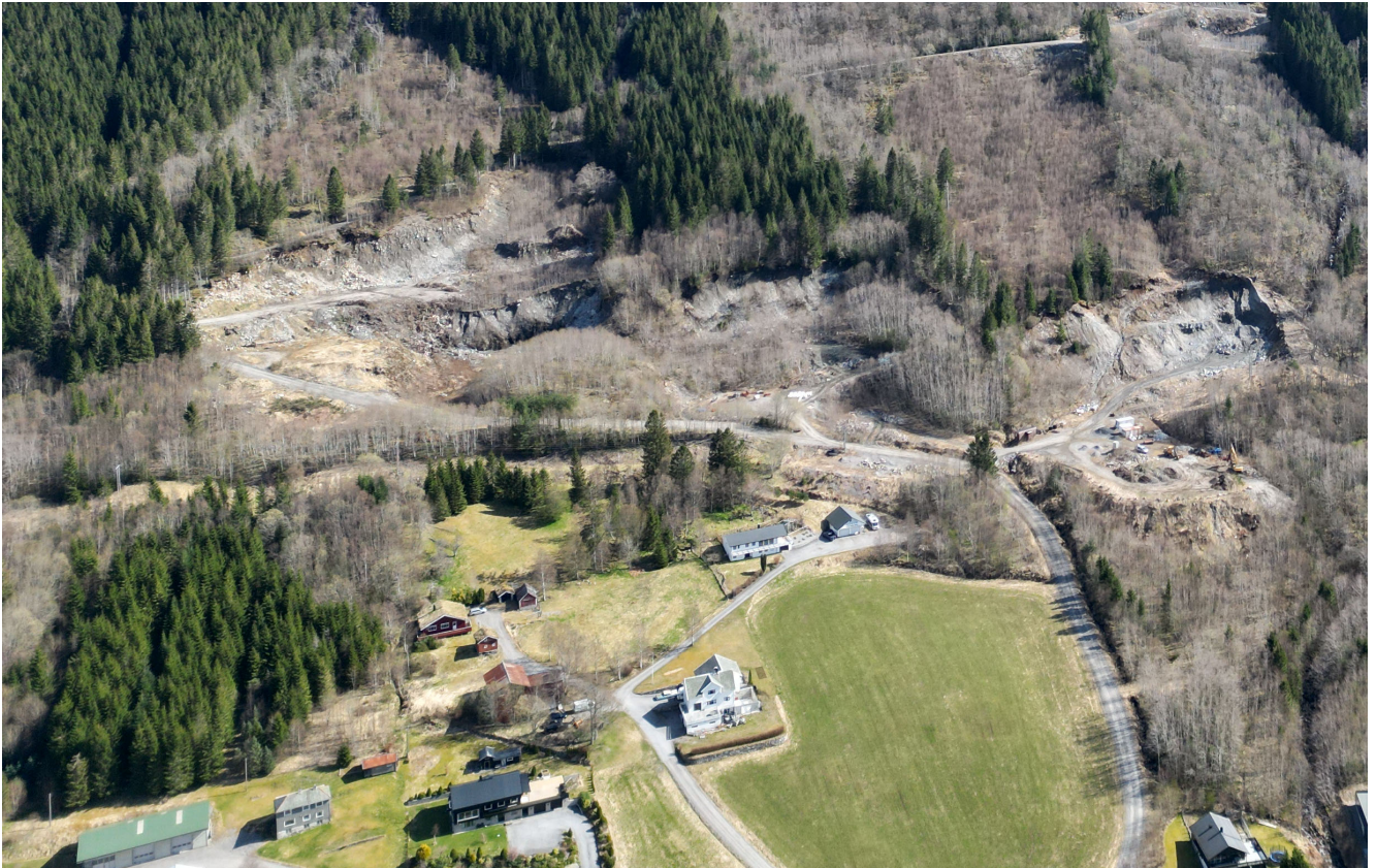
Bilde 11: Sandtak i overkant av bebyggelsen ved Langstein. Sandtakene har utforming som større groper og har potensiale for å magasinere store mengder snø- jord og flomskredmasser.
