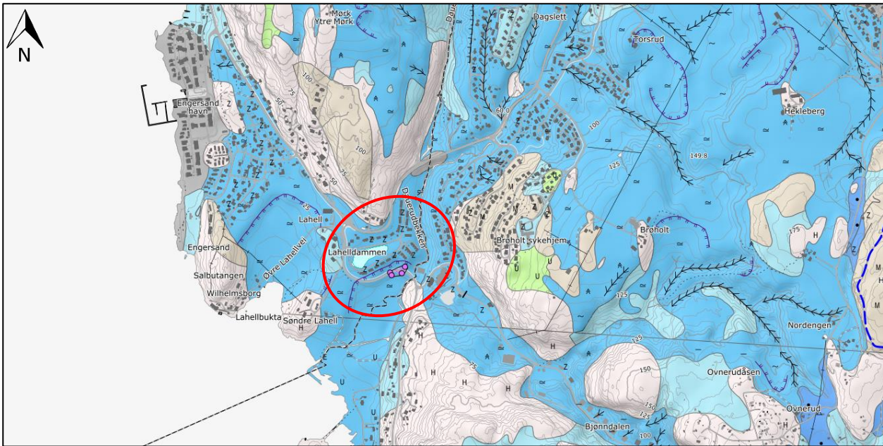
Figur 37 Lahell er markert med rød sirkel. NGUs løsmassekart har kartlagt området som hav- og fjordavsetning. Kartleggingen beskriver området som sammenhengende dekke med stedvis stor mektighet. Kilde: https://geo.ngu.no/kart/losmasse_mobil/ (Kartlagt målestokk 1:20 000).
