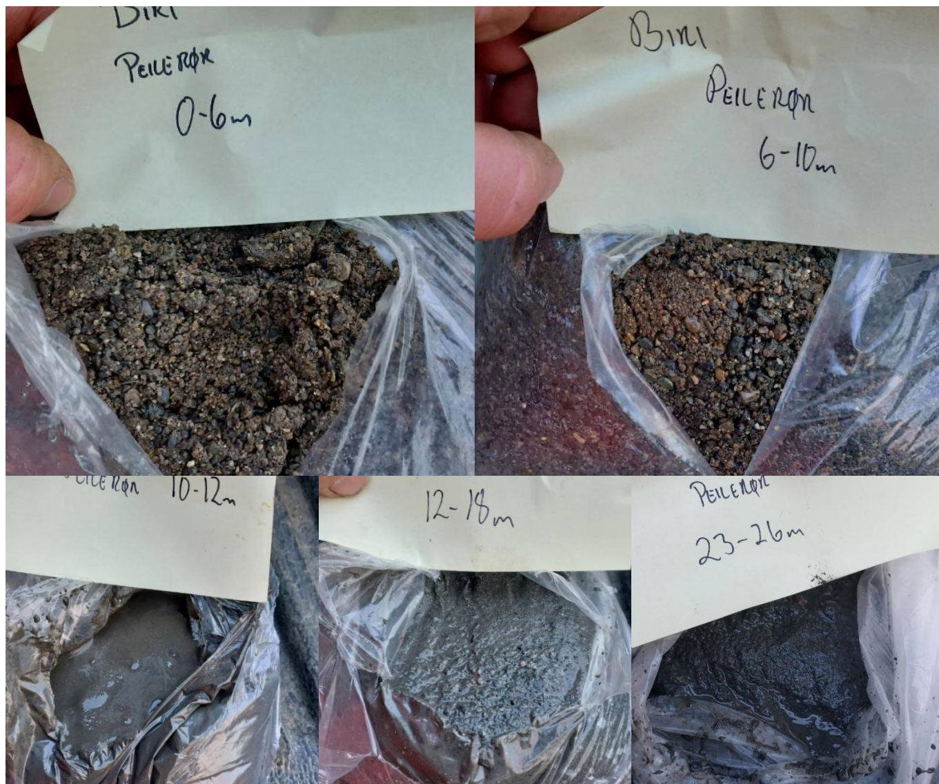
Figur 6: Bilder av masser ved boring av observasjonsbrønn.
