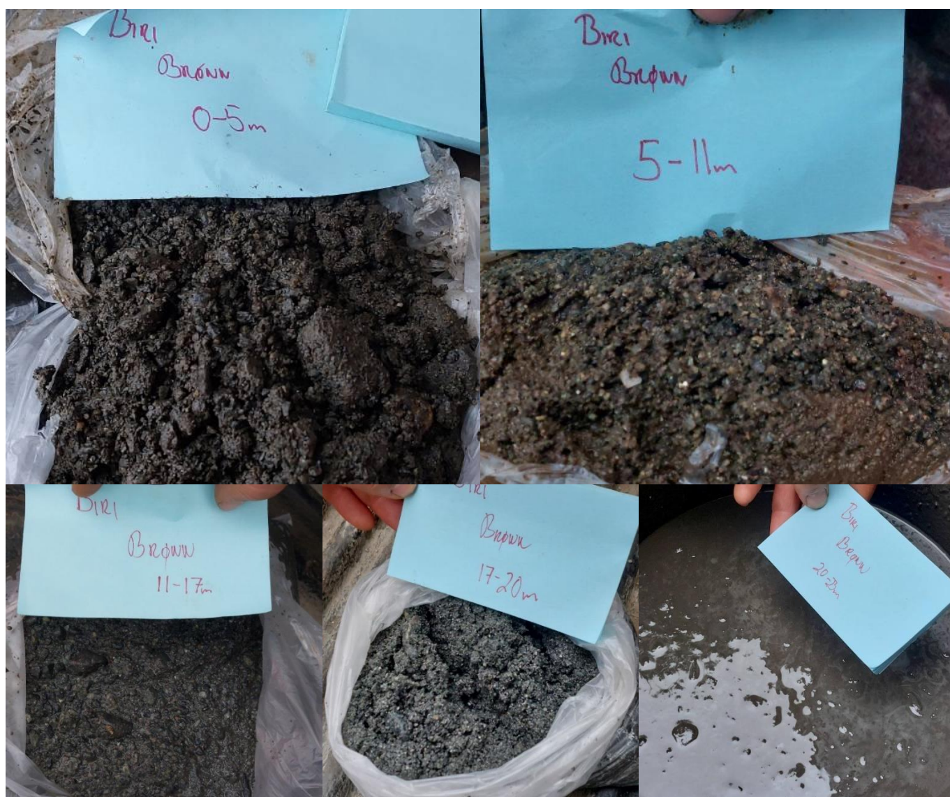
Figur 5: Bilder av masser ved boring av borebrønn.
