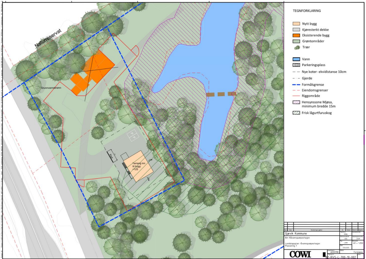
Figur 4: Utklipp fra foreløpig landskapsplan som viser områder der råvannspumpestasjonen (RVS) skal etableres. RVS er markert som lys oransje boks «Nytt bygg». Stiplet blå linje viser regulert område for RVS, heltrukket rød linje viser foreløpig riggområde [5], lilla skravur viser 15 meters grense fra vannlinjen med kantvegetasjon som skal bevares. Grønn skravur viser hensynssonen til naturtypen «frisk lågurtfuruskog». Endringer vil forekomme da det fortsatt arbeides med landskaps- og riggplan. Tegning utarbeidet av COWI.
