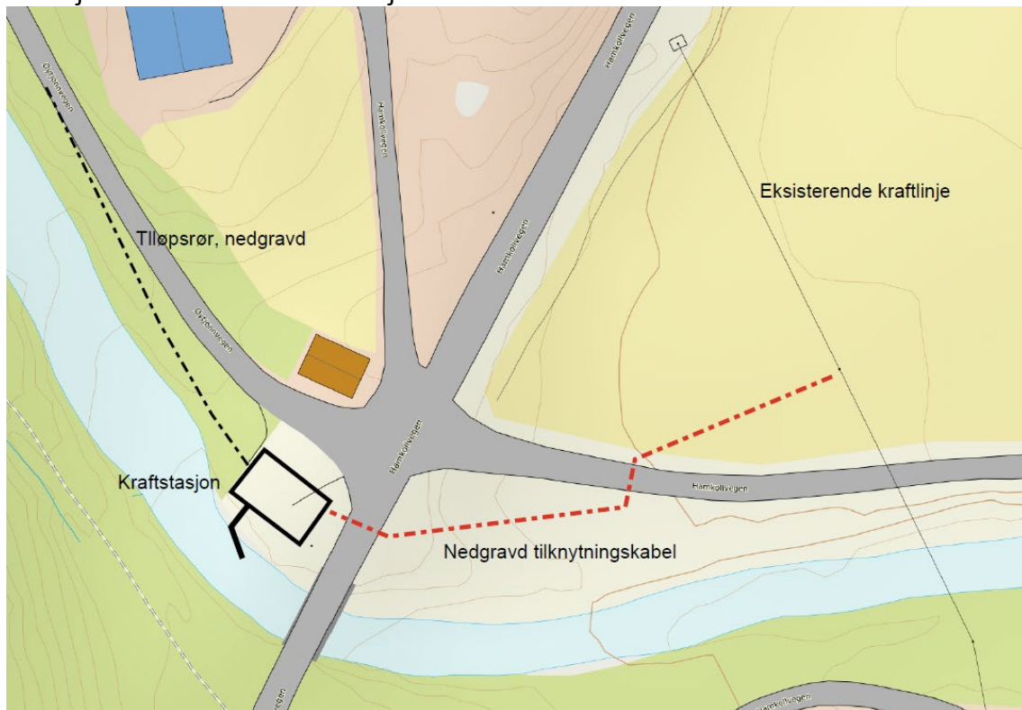
Figur 8. Oversiktskart kabeltrasé for tilknytning til eksisterende kraftlinje
