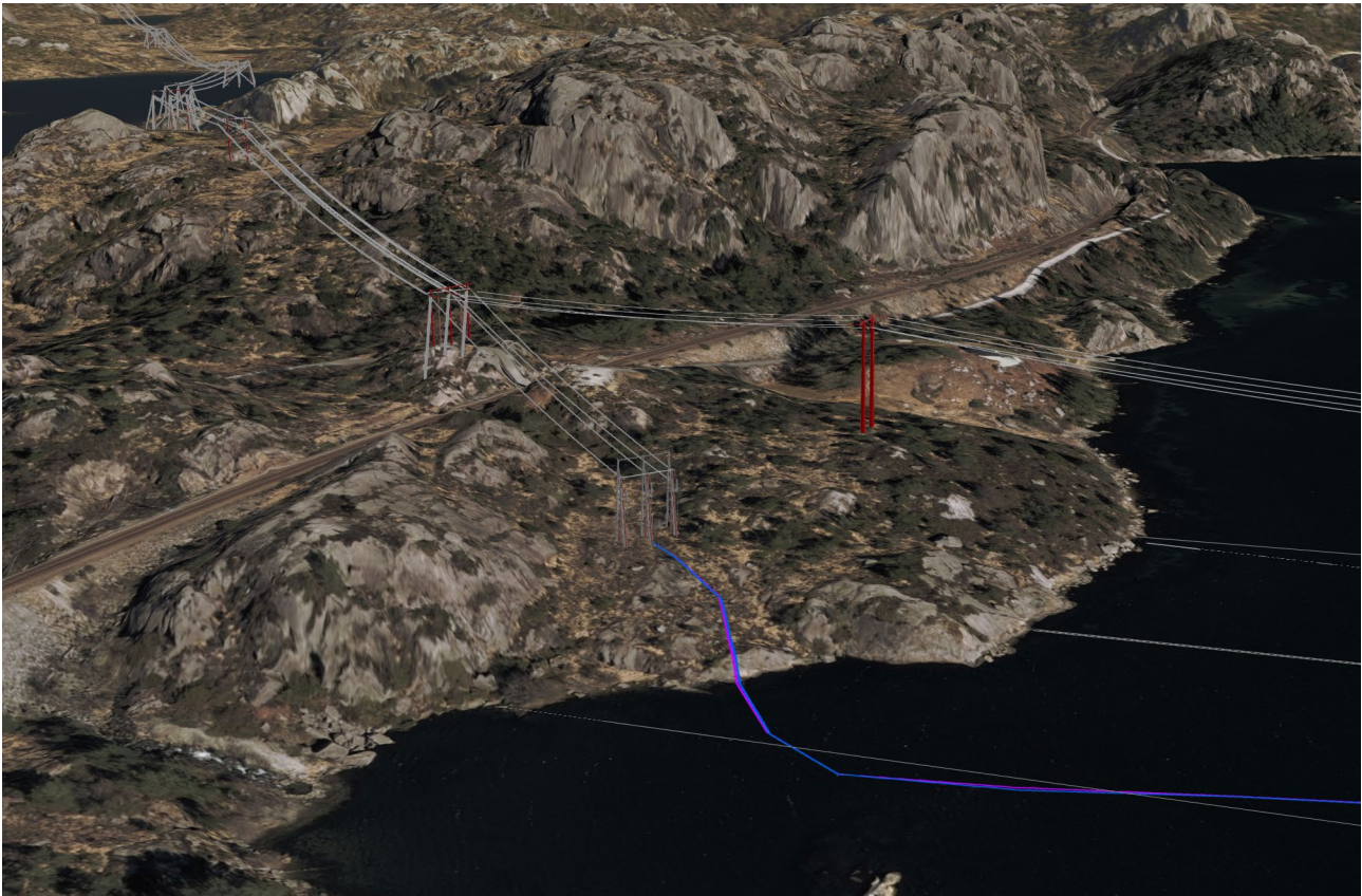
Figur 53 Utsnitt fra 3D-modell som viser begge alternative løsninger ned mot Nordra Sundet. Alternativ 1 går i luftlinje over sundet, mens alternativ 2 og 3 går til en endemast og krysser sundet i sjøkabel.
