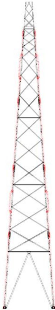
Figur 29 Eksempel på forsterkning av eksisterende master
