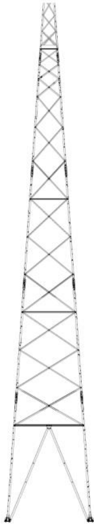
Figur 29 Eksempel på forsterkning av eksisterende master
