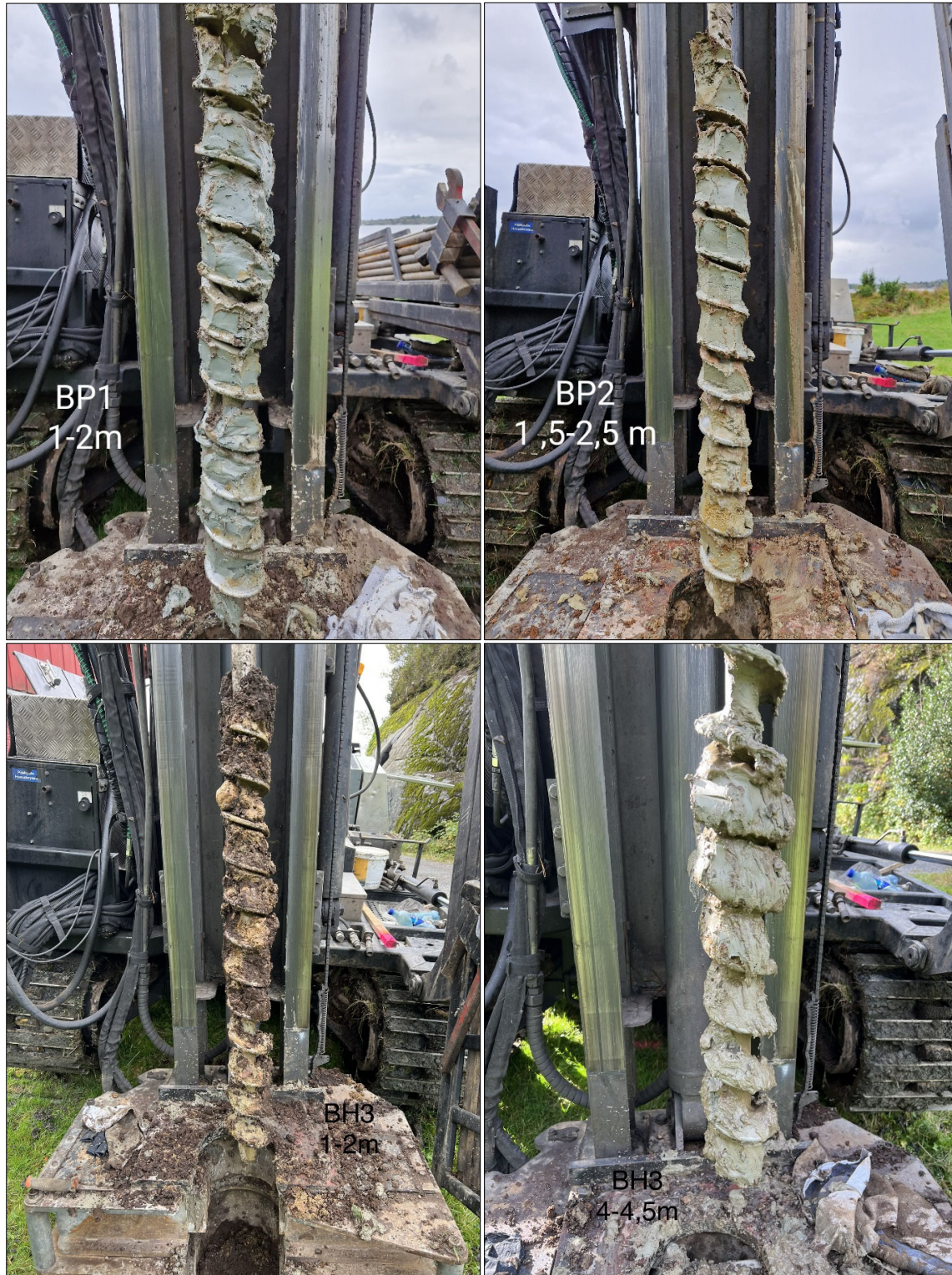
Figur 7. Løsmasser langs naver i BP1, BP2 og BP3. Løsmassene viser siltig leirig masse på 1-2 m i BP1, 1,5-2,5 m i BP2 og 4-4,5 i BP4. Ved 1-2 m i BP3, er det sand med innhold av silt, grus og jord.
