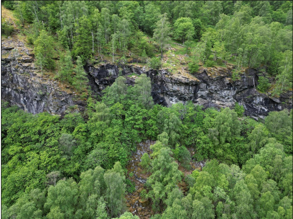
Figur 5: Dronebilde av den laveste bergskrenten, nærmeste kartleggingsområdet (ca. 130 m fra kartleggingsområdet). Bildet er tatt mot nord. Bildet viser oppsprukket berg med flere delvis avløste blokker og ur i nedkant av skrenten.
