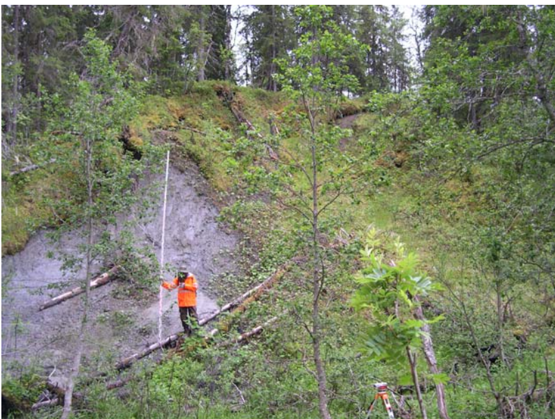
Bilde 2: Fersk utglidning i eldre rasgrop. Staven er fem meter høy. Like oppstrøms P410.
