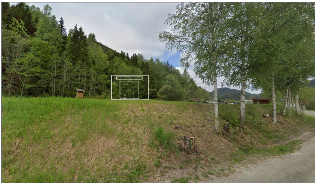
Figur 8-6: Portal til tverrslag er skissert, og i forkant av portalen vil det opparbeides et riggareal. Bilde hentet fra google streetview, på veien like nord for utløpskanalen fra Uvdal kraftverk. Foto mot nord.
