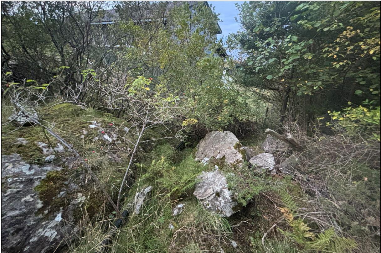
Figur 27: Ytterste observerte steinsprangblokker, omtrent 6 m nordøst for kartlagt område. Plassering av blokkene er markert ved infopunkt 2.
