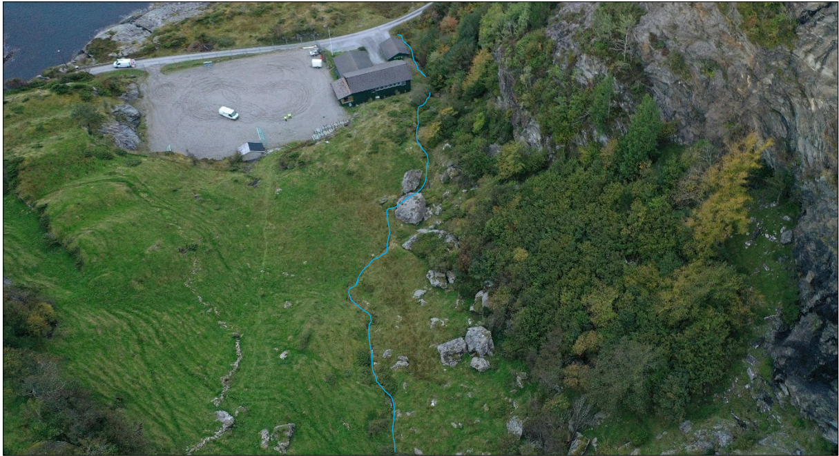
Figur 15: Bildet viser dreneringsveien i sørlige deler av påvirkningsområdet, som renner fra Heia. Dreneringsveien renner i slakt hellende terreng, stedvis på bart fjell og stedvis i tynne løsmasser av jord (10-30 cm).
