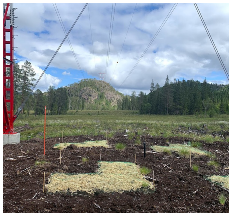
Figur 33: Forsøksfelt under mast for å teste metodikken. Torvmosefeltene ble dekket med halm og plastnett den første vekstsesongen.
