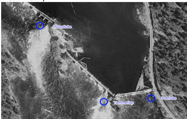
Figur 1. Flyfoto (Norge i bilder 1958) viser plassering av hovudluker, tømmerløp og botnluke på nåledam.
