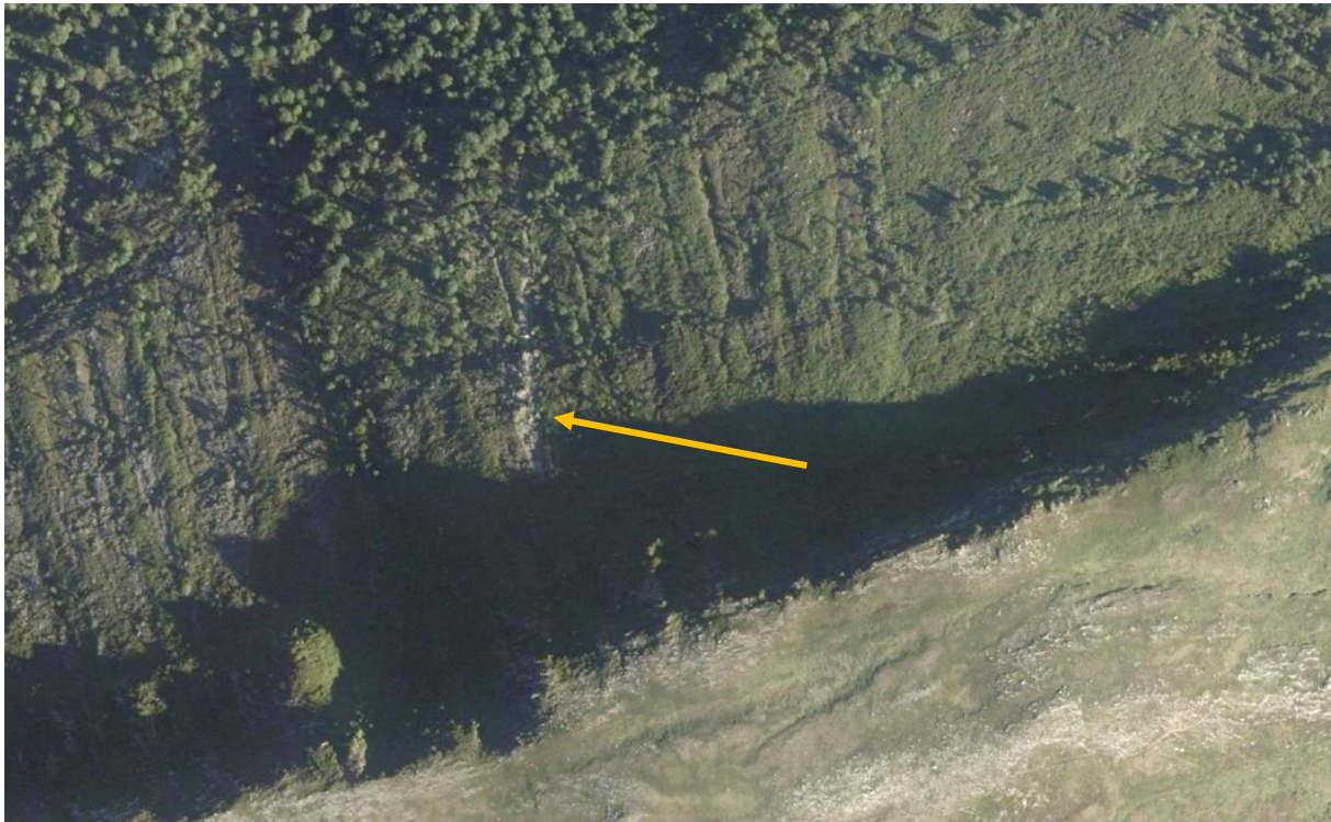
Figur 12: På flybilete frå 2018 er det synleg eit relativt ferskt, mindre skredsår i øvre del av fjellsida (oransje pil). Det ser også ut til å vere fleire eldre skredsår bortover lia omtrent i same høgd.
