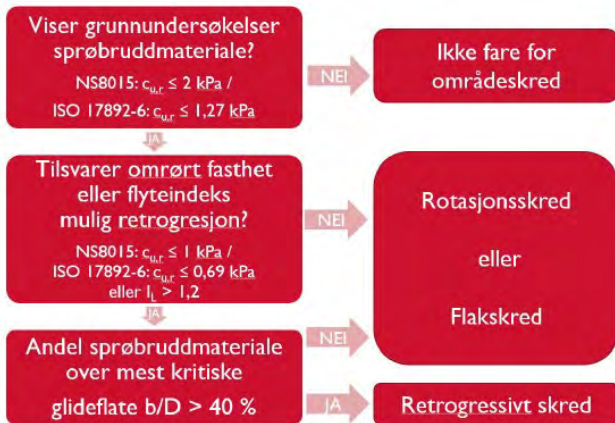
Figur 4.7 Flytskjema for vurdering av aktuell skredmekanisme, ref. [2].
