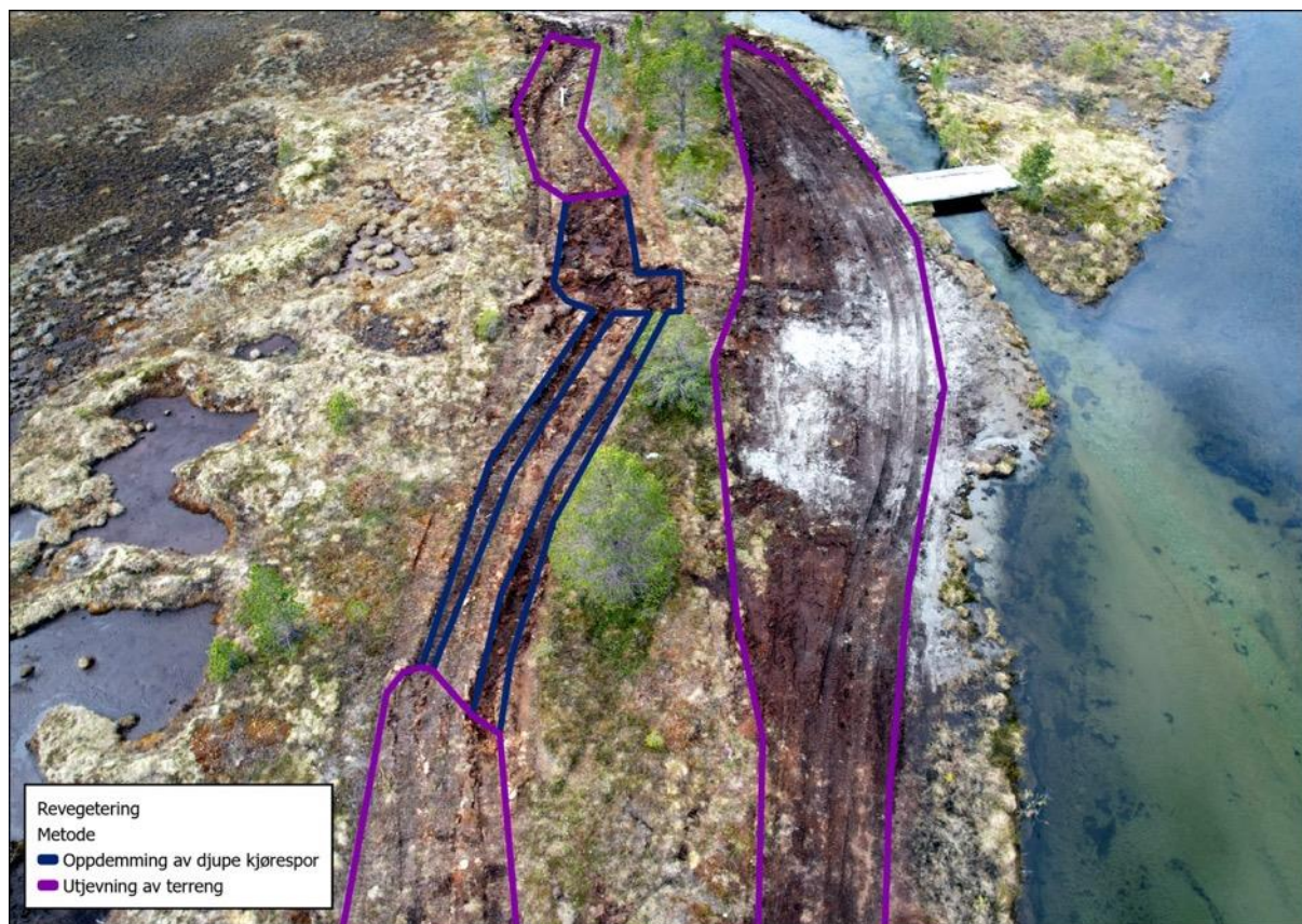
Figur 10. Eksempel på tilnærming ved enden av traseen over myra ved starten av kanalen.
