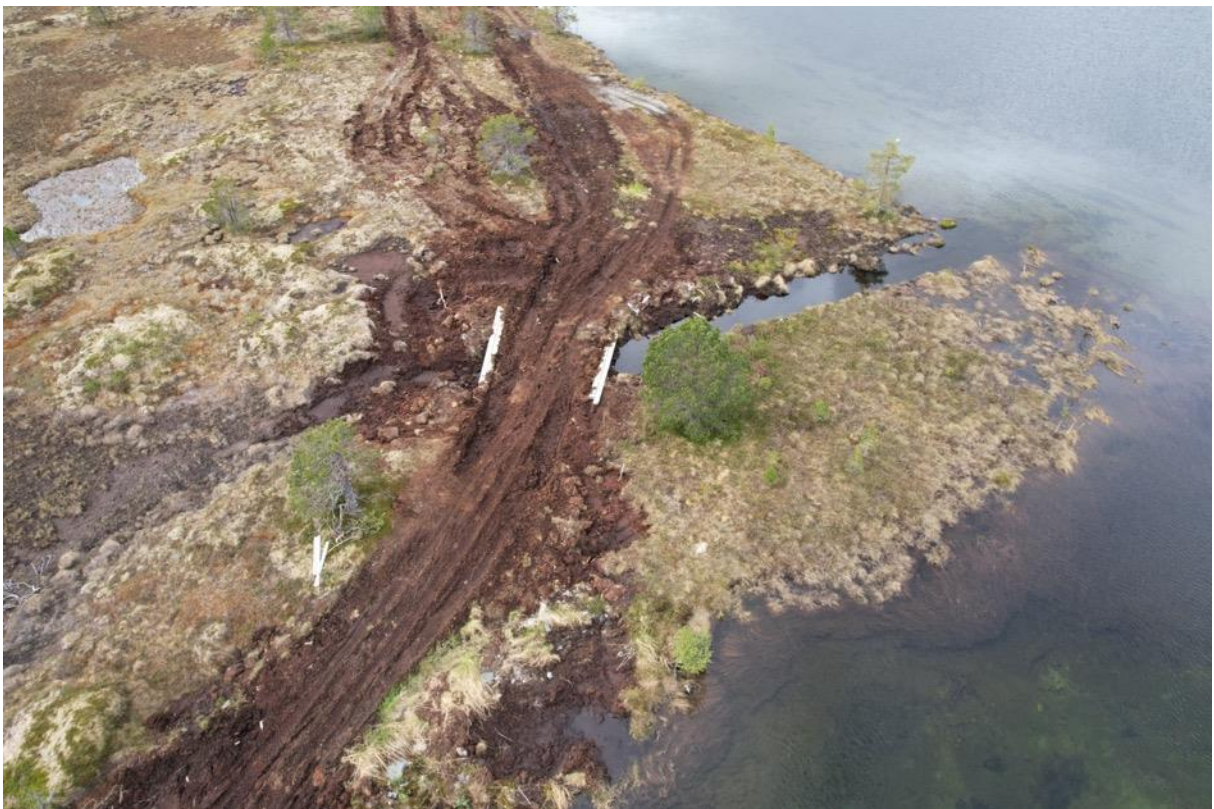
Figur 5. Partier med djupe kjørespor på myr i forbindelse med eksisterende trasé.
