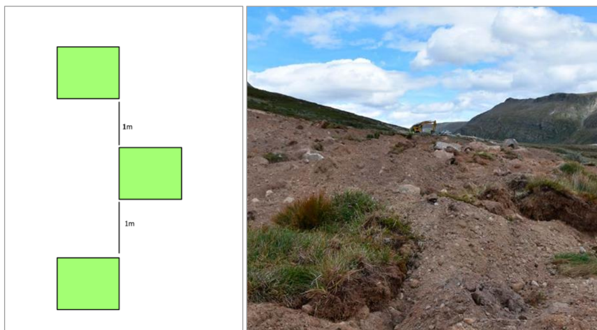
Figur 8. prinsippeskisse for utlegging av lyngmatter (venstre) og eksempel hentet fra Hagen, mfl. 2022. Legg også merke til hvor «rufsete» toppmassene er lagt ut.
