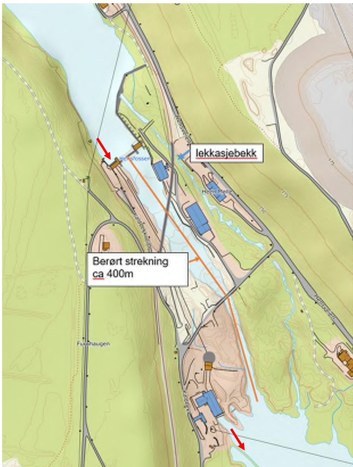
Figur 1.4. Hensfoss kraftverk med berørt strekning som følge av ny dam. Blå pil til «lekkasjebekk» og røde piler viser kraftverkets inntak og utløp.
