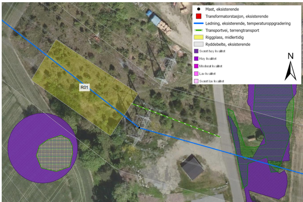
Figur 5-25 Oversiktsbilde/ortofoto over terreng og tiltaksområde ved R01, ved mast 1 Flesaker-Hof. Riggområdet legger ikke beslag på registrerte naturverdier eller dyrket mark.
