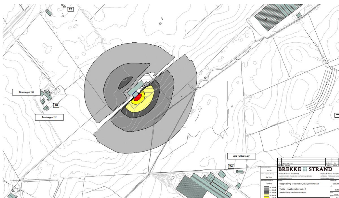
Figur 17 Beregnet støy nivå for Tjøtta transformatorstasjon, alternativ 5
