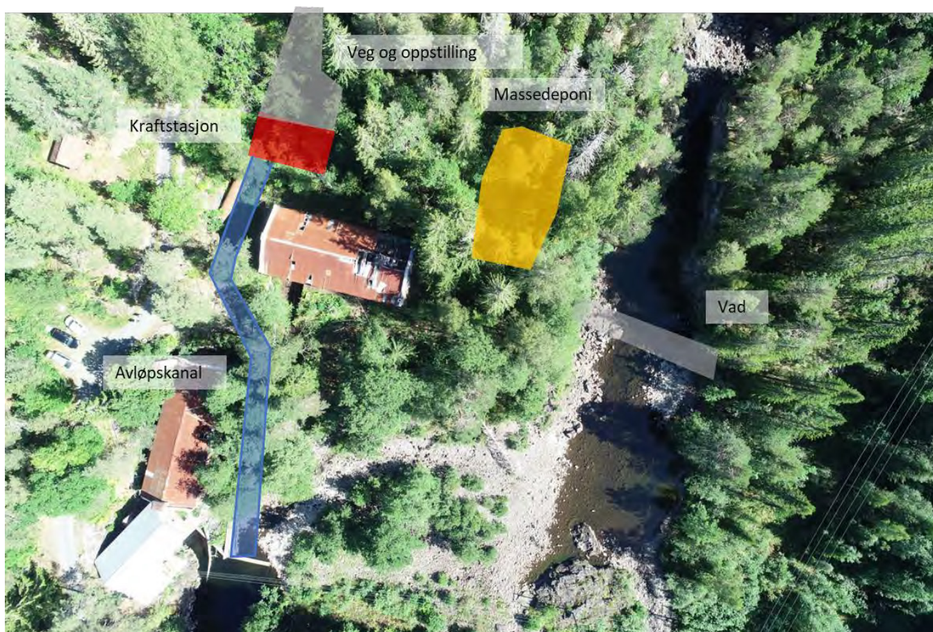
Figur 11 Bilete frå kraftstasjonsområde der plassering av kraftstasjon, avløpskanal, vad og massedeponi er vist.
