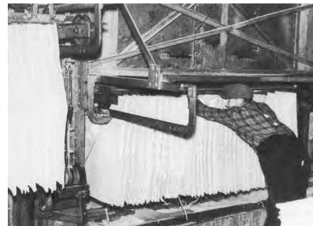
Masseark henges opp i en vogn i tørkekanalen ved tresliperiet i Søndeled. Dette var i prinsippet samme måte som tidligere var brukt på Stifoss. Kilde: Vevstad, Andreas. "A/S Egelands Verk". Utg. Egelands Verk. 1988
