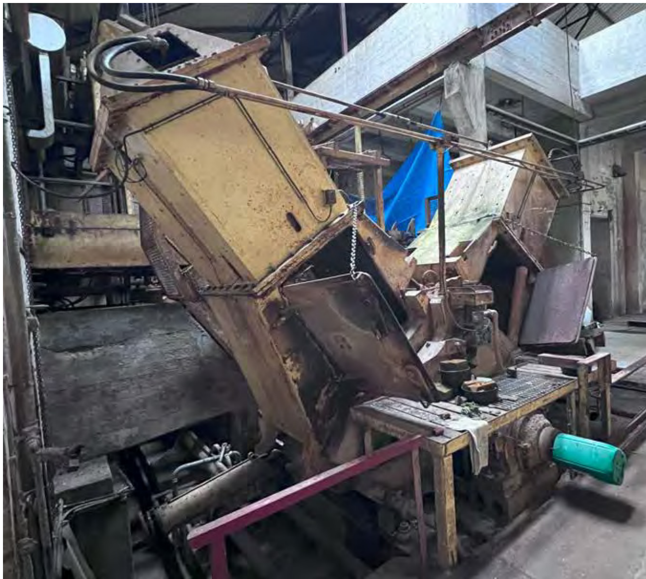
Bevart slipeapparat på Søndeled tresliperi, sist brukt i 1998.
