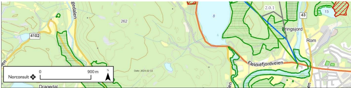
Figur 3-2. Konsekvensutredet trasé 2.0.1 vist med grå strek. Konsesjonssøkt trasealternativ 2.0 vist med blå strek. Grønn strek dagens 110 kV ledning som skal rives. Verneområder vist med rød skraver og viktige naturtyper (Håndbok 13) vist med grønn skraver.
