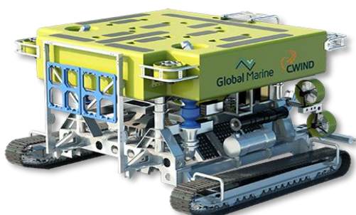
Figur 2-2. Undervannsfarkost for grøfting av kabel. Kilde: global-marine.co.uk
