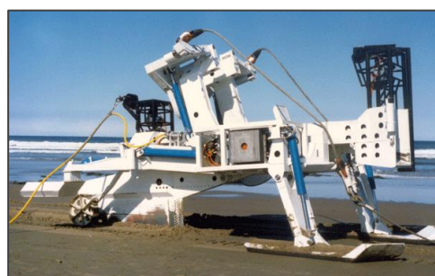
Figur 2-3. Undervannsfarkost for kabelinstallasjon ved pløying. Kilde: kis-orca.eu
