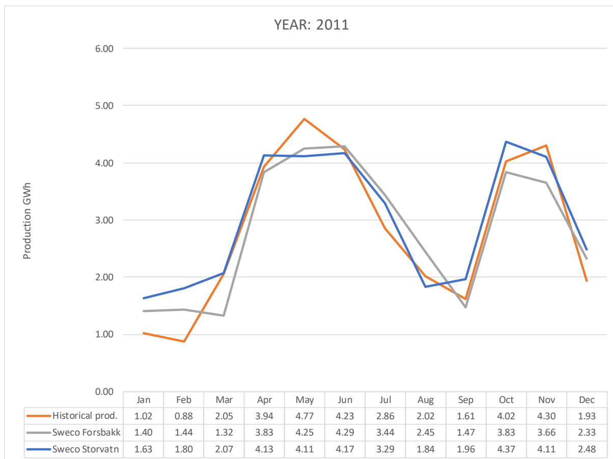
Figur 4 Historisk og simulert produksjon Ildgrubfossen kraftverk år 2011
