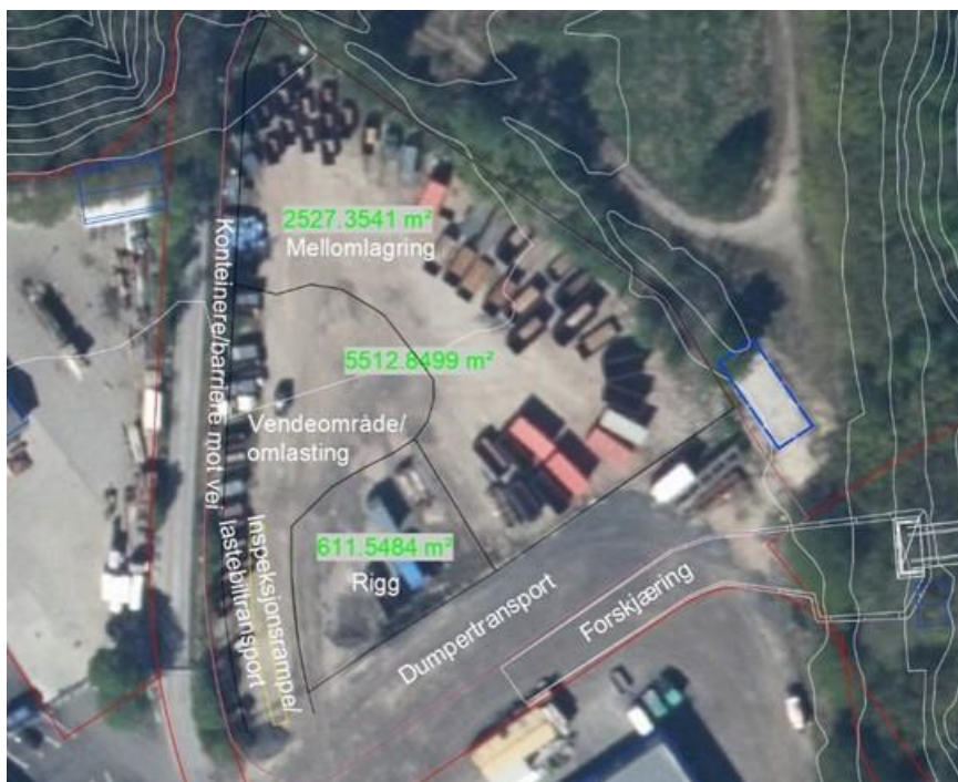
Figur 2-2. Omlastingsområde for tunnelmasser.
