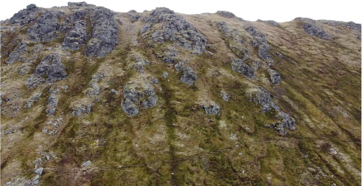
Bilde 5: Nordlig del av påvirkningsområdet. Viser løsneområder for steinsprang og spor etter våte snøskred.
