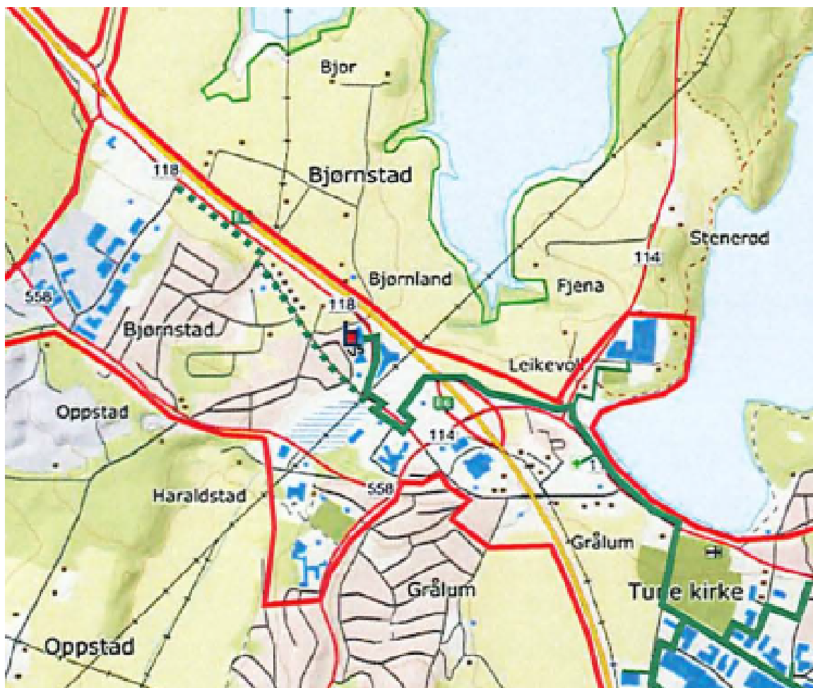
Figur 1 – utsnitt av nytt konsesjonskart med nytt fjernvarmenett i Bjørnstadveien tegnet med stiplet linje
