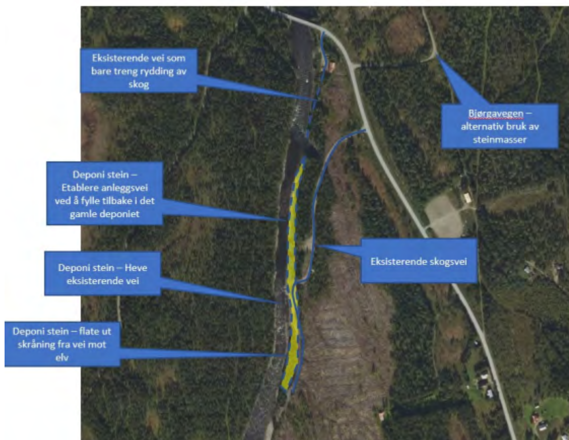
Figur 2: Planlagt arealbruk ved utløpet i NEA fra Gresslifoss kraftstasjon. Arealbruksplanen må revideres i henhold til gitte forutsetninger i vedtaket.
