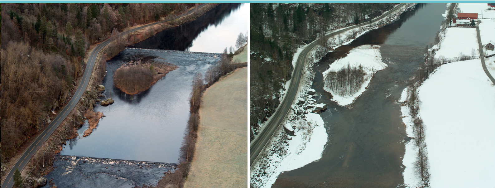
Før og etter fjerning av to av tersklene. Flyfoto på vintervannføring (6 m 3 /s). Foto: Tor Kviljo
