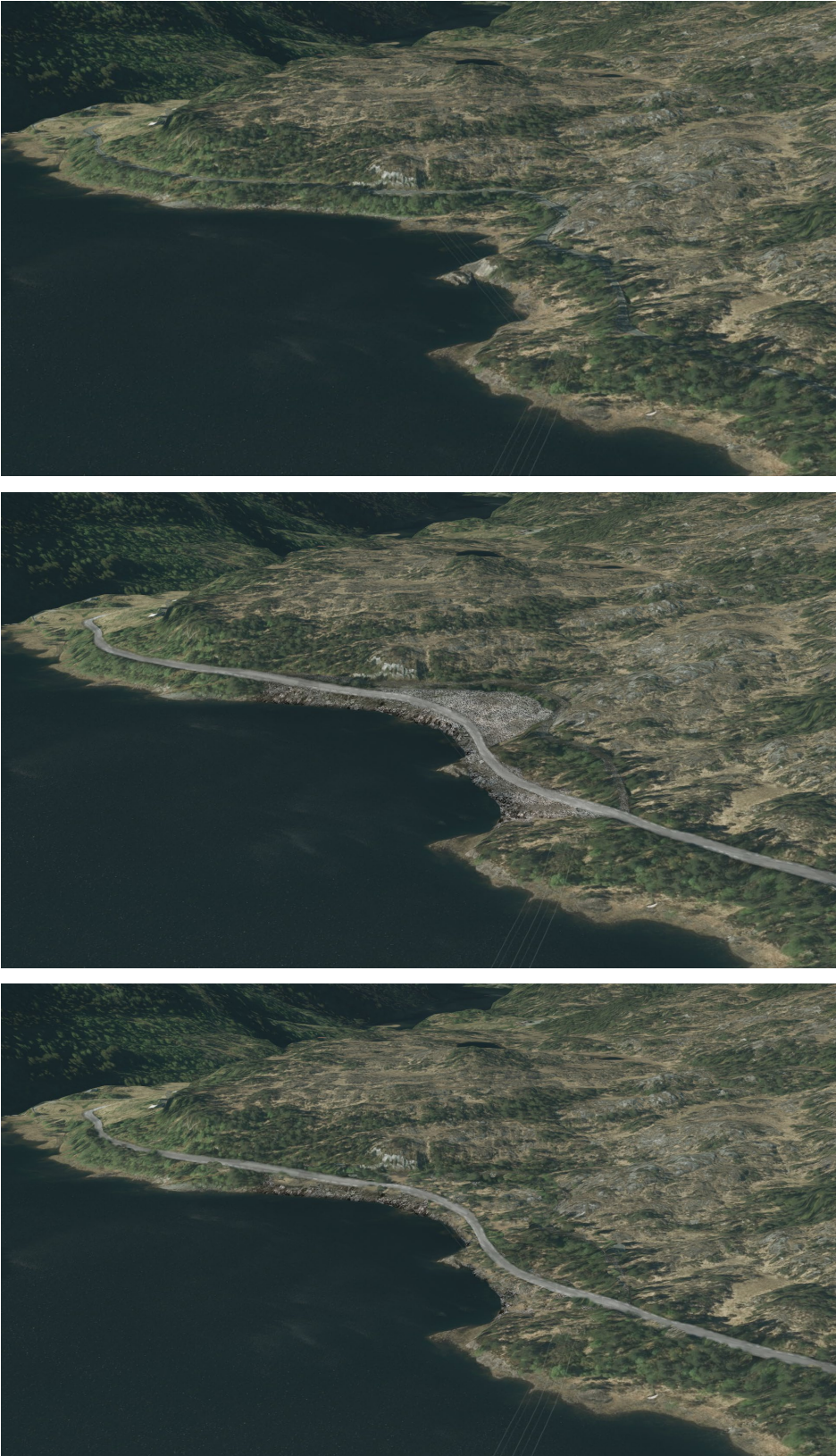
Figur 3-25 Visualisering av planlagt deponi med veg over i/ved Grøndalsvatnet. Fra øverst til nederst; dagens situasjon, situasjon etter anleggsperiode og revegetert situasjon. Bakgrunnsbilde for visualisering: Norge i Bilder 3D.
