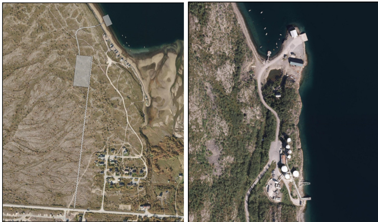
Figur 6. Flyfoto av Kunes (til venstre) og Hamnbukt (til høyre). Ved Hamnbukt vil det ikke bli behov for nye utbygginger, mens det ved Kunes vil bli etablert en ny dypvannskai og et ca. 10 daa stort område for mellomlagring av turbinkomponenter.
