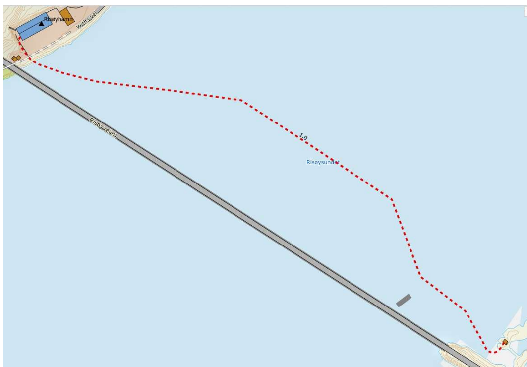
Figur 2-2: Planlagt trasé for de nye 132 kV sjøkablene over Risøysundet.
