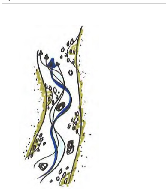
Figur 15-16. Bekkekanten bør være variert og ikke en plastret, glatt kanal. Bekken gis et buktende preg som vil gi variasjon i vannhastighet, dyp og substratfordeling og større tilgjengelig areal. Dette er gunstig både for fisk og bunndyr og for det generelle landskapsinntrykket. Innslag av større stein skaper standplasser for fisk. Etablering av vegetasjon vil bidra med skjul for fisk, samt gi tilførsel av organisk materiale og næringsstoffer. Illustrasjoner: Turid Stærnes.
