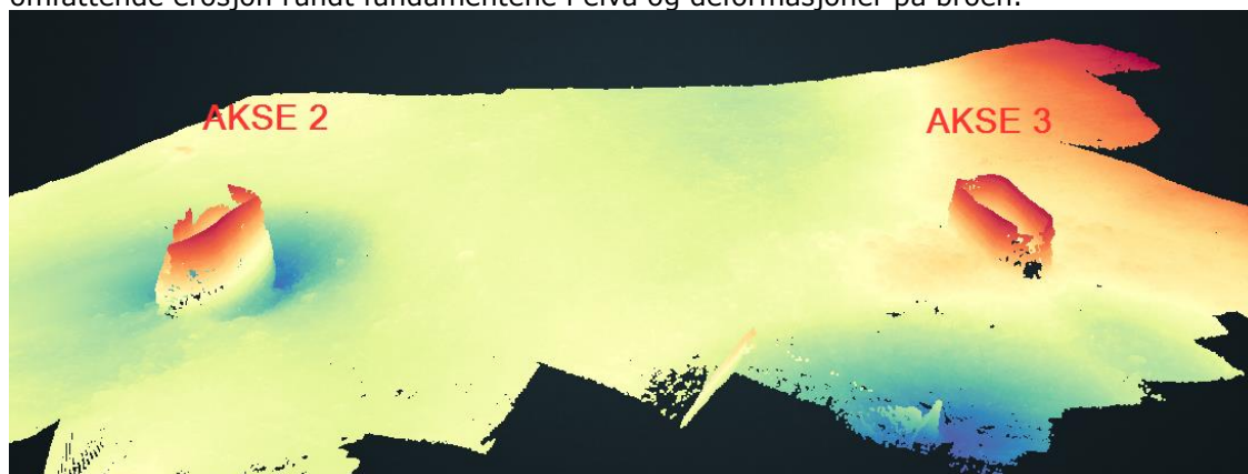
Figur 1-2: Skann av elvebunnen utført av Scan Survey i etterkant av flommen [2]
