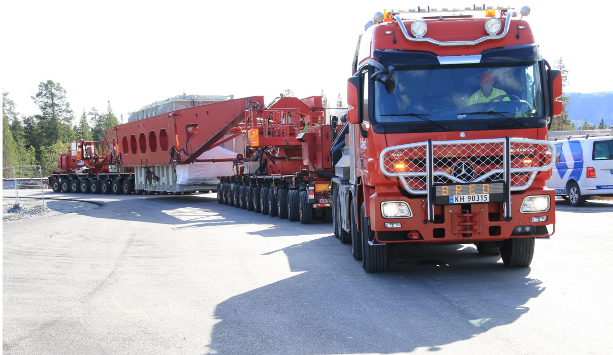
Figur 11. Bildet viser Statnetts transport av 420 kV transformator til Skillemoen transformatorstasjon i Alta i 2020. Tilsvarende transport vil bli utført til Hyggevatn transformatorstasjon. Transportens totale lengde er 72 m.
