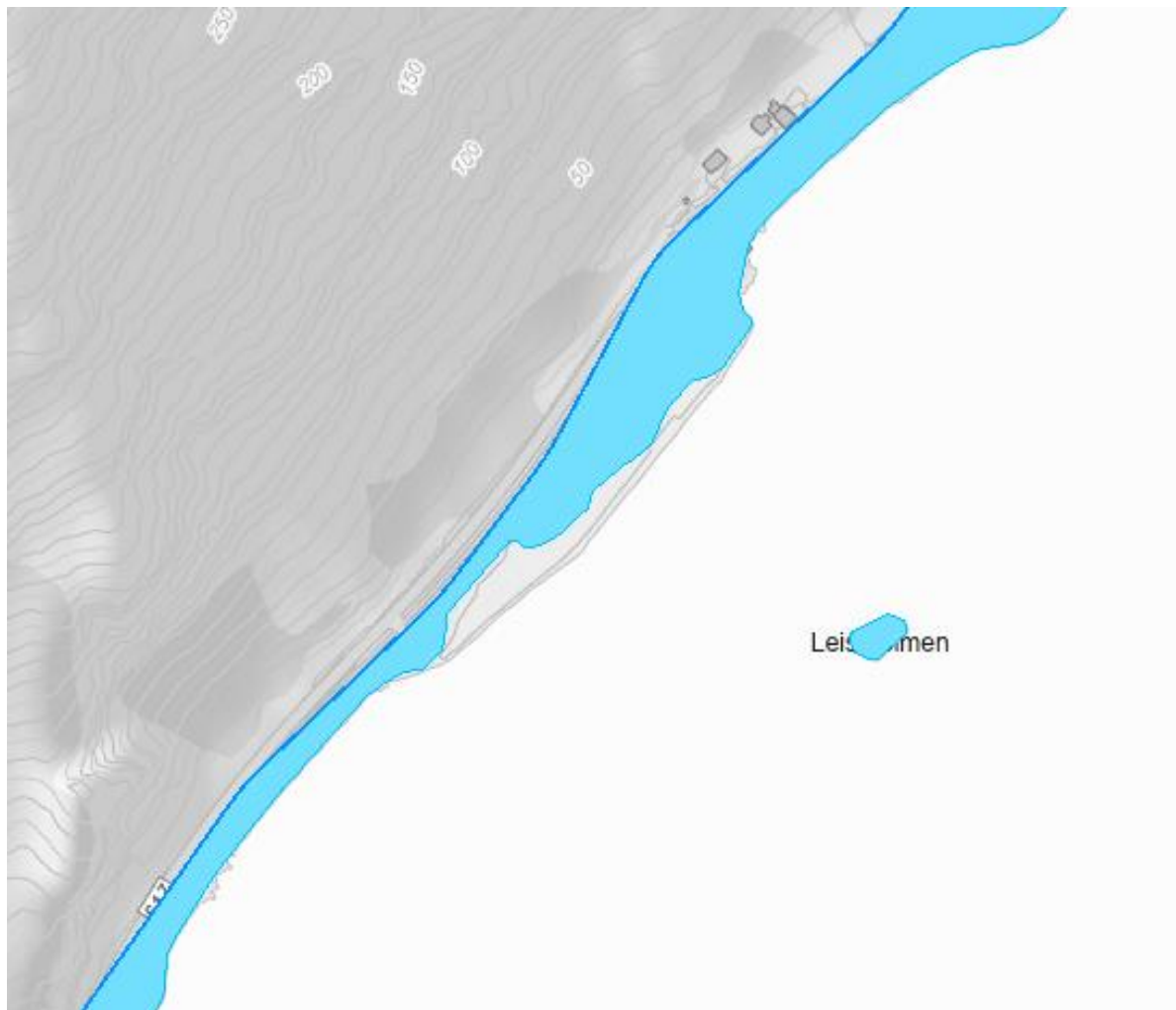
Figur 4-6 Utsnitt fra NVEs faresonekart over Skårastranda. Blå markering angir aktsomhetsområder med tanke på mulig forekomst av marin leire. (Kilde; NVE [10])
