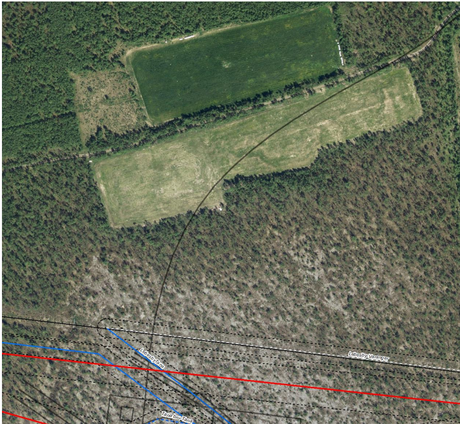
Figur 4-8. Foreslått adkomstvei inn til Tana transformatorstasjon. Som avbøtende tiltak anbefales det å flytte adkomstveien vest for fulldyrket areal.
