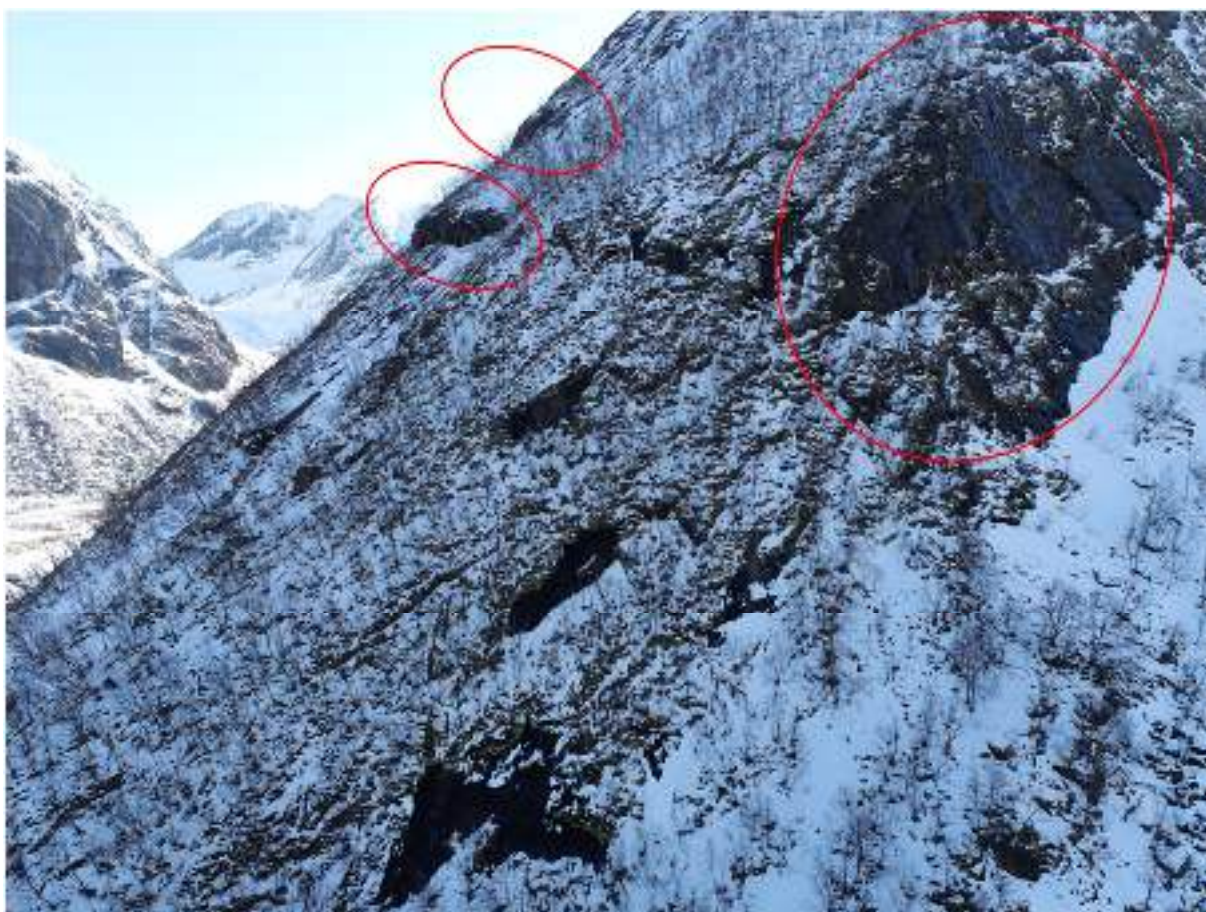
Figur 17: Oversiktsbilde av potensielle løsneområder for steinsprang tatt mot øst (fra ca. kote 150 og 190 ved bergskrenter og fra ca. kote 100-140 ved svaberg) opp mot Hatten, er markert med rødt.
