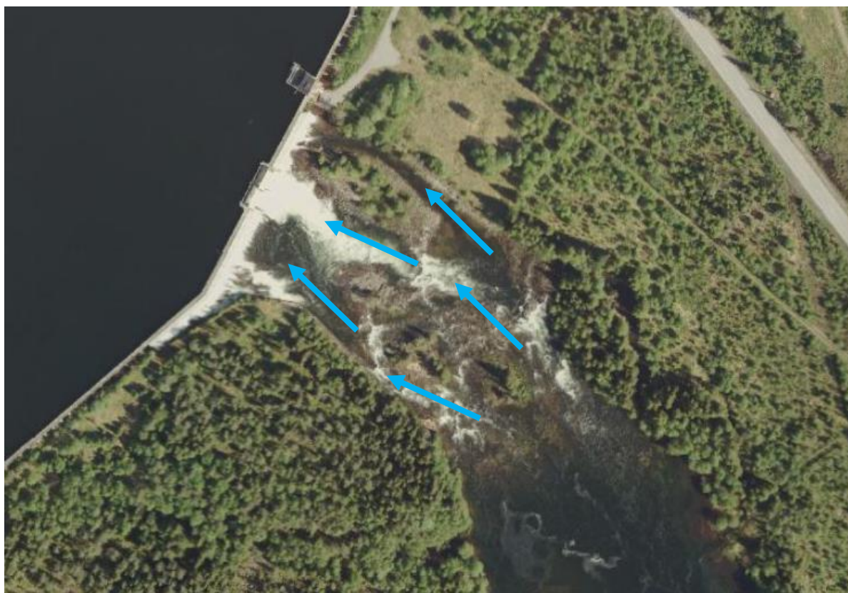
Figur 13. Sannsynlige oppvandringsruter for fisk under dammen ved høy flomvannføring (vannslipp gjennom segmentluker).
