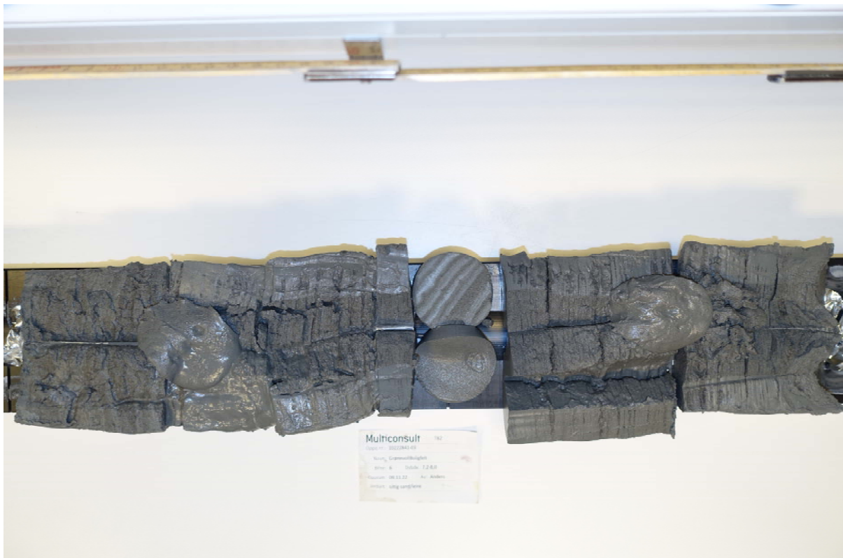
Figur 4-5: Prøve med siltig leire fra borpunkt 2022-6, dybde 7,2-8,0 meter. Leira er lagdelt og ustabil.
