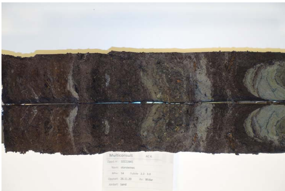
Figur 4-2 I borpunkt 14 er det lagdelt materiale med lag av sandig, siltig materiale og lag av humus til 4 m dybde.
