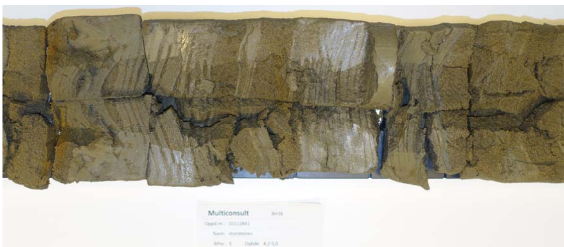
Figur 4-3 I borpunkt 5 er det sand ned til 8,5 m dybde. Bildet viser siltig sand fra 4,2-5,0 m dybde.
