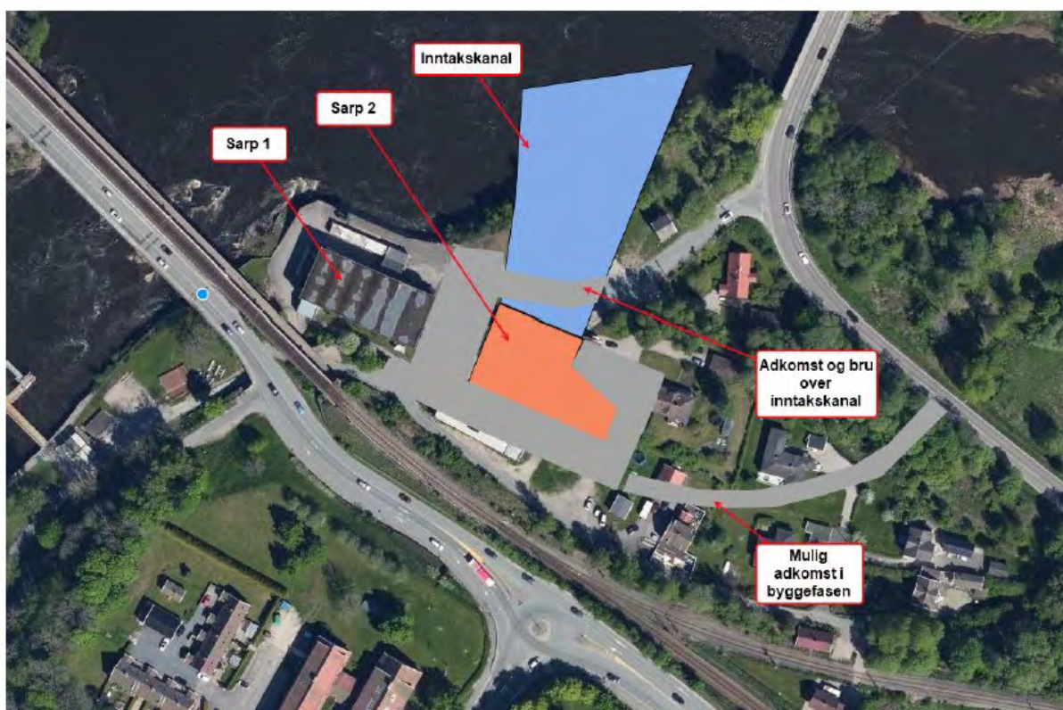
Figur 4-1 Plassering av inntak og inntakskanal. Kilde: Norconsult
