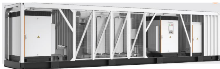
Fig. 13. Eksempel på kompakt container løsning som inneholder sentralinverter (DC til AC), transformator 900 V til 22 kV, og 22 kV høyspenningsanlegg. Her vist med 6,3 MVA transformerskapasitet. Vekt ca. 25-30 tonn. Dimensjoner ca. 12 x 3 x 2,4 m. Installerer på en betongplate/fundament.
