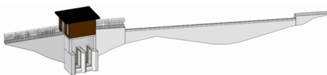
Figur 1: 3D-modell av ny dam og nytt lukehus. Illustrasjonen er hentet fra fremlagt detaljplan.
