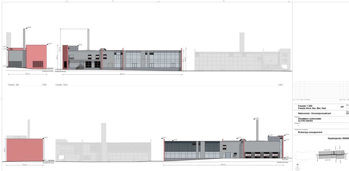
Figur 4 – Fasadetegninger – ny varmesentral på Brakerøya – fasade vist fra nord, øst og vest.
