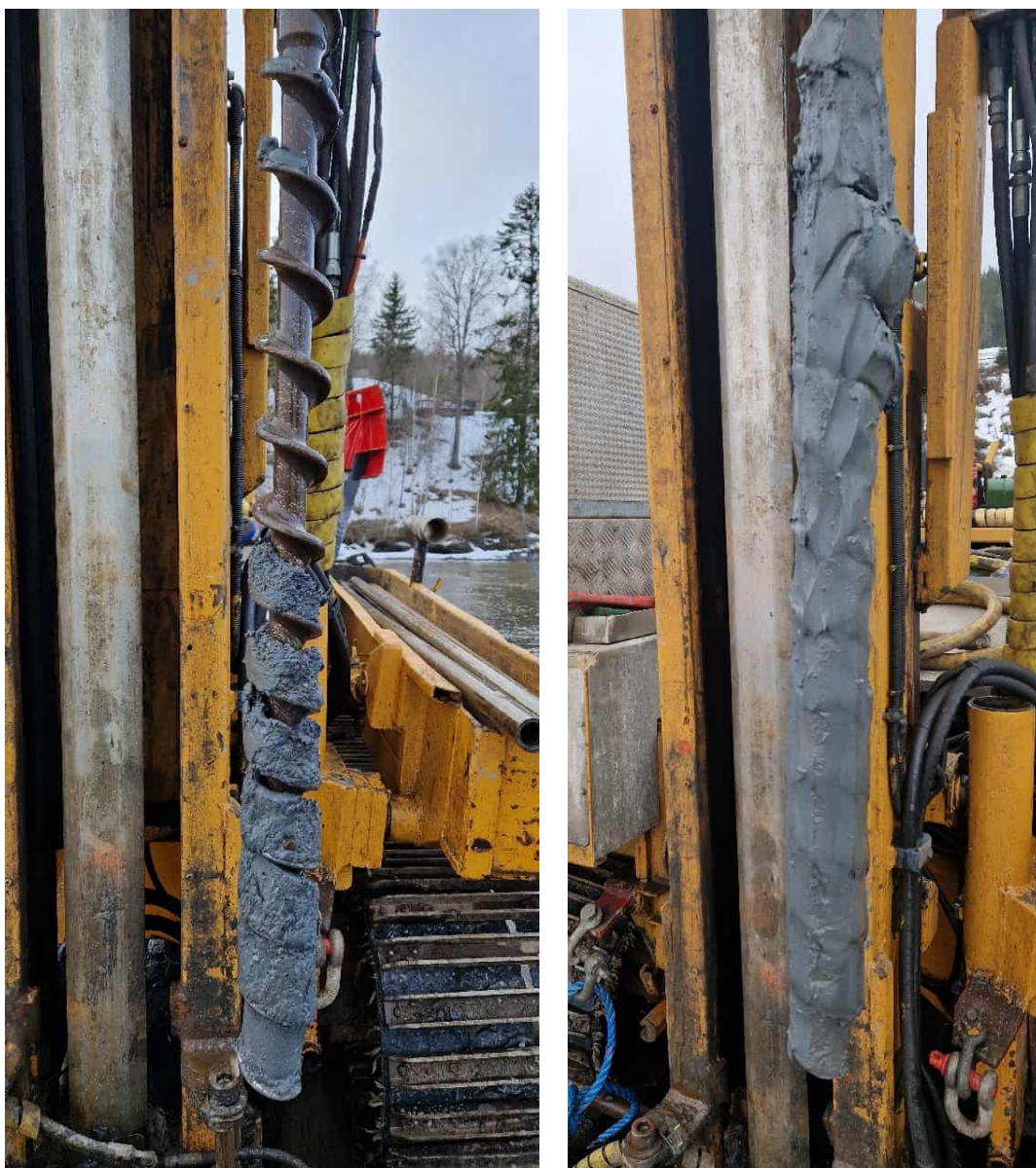
Figur 6: Eksempelbilde av prøvetaking fra flåte med borerigg.
