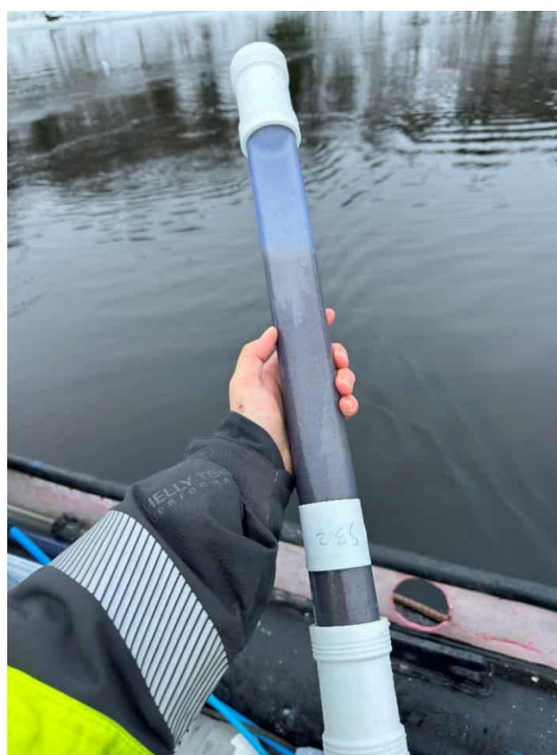
Figur 4: Eksempelbilder av prøvetakingsrør med varierende mengde sediment.
