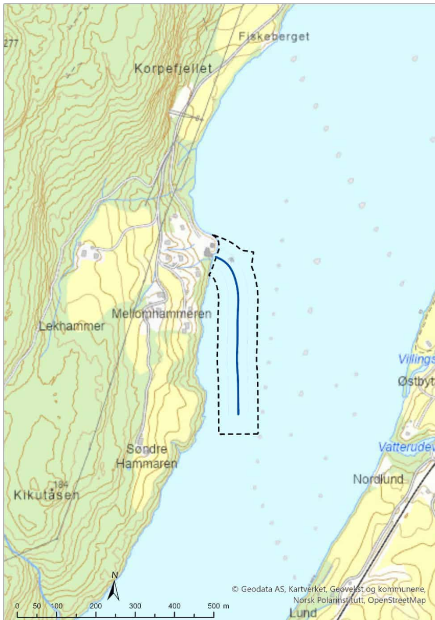
Figur 1: Planlagt trasé inntaksledning vist som blå strek, med omriss rundt den definerte sikringssonen.
