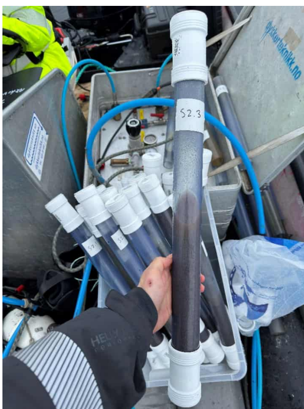
Figur 4: Eksempelbilder av prøvetakingsrør med varierende mengde sediment.
