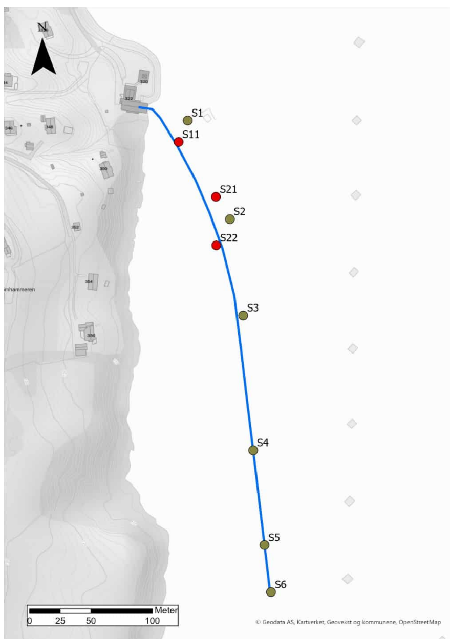
Figur 3: Prøvetakingsstasjoner, der grønne sirkler indikerer prøvepunkter for sedimenter og røde sirkler indikerer prøvepunkter for geoteknikk.
