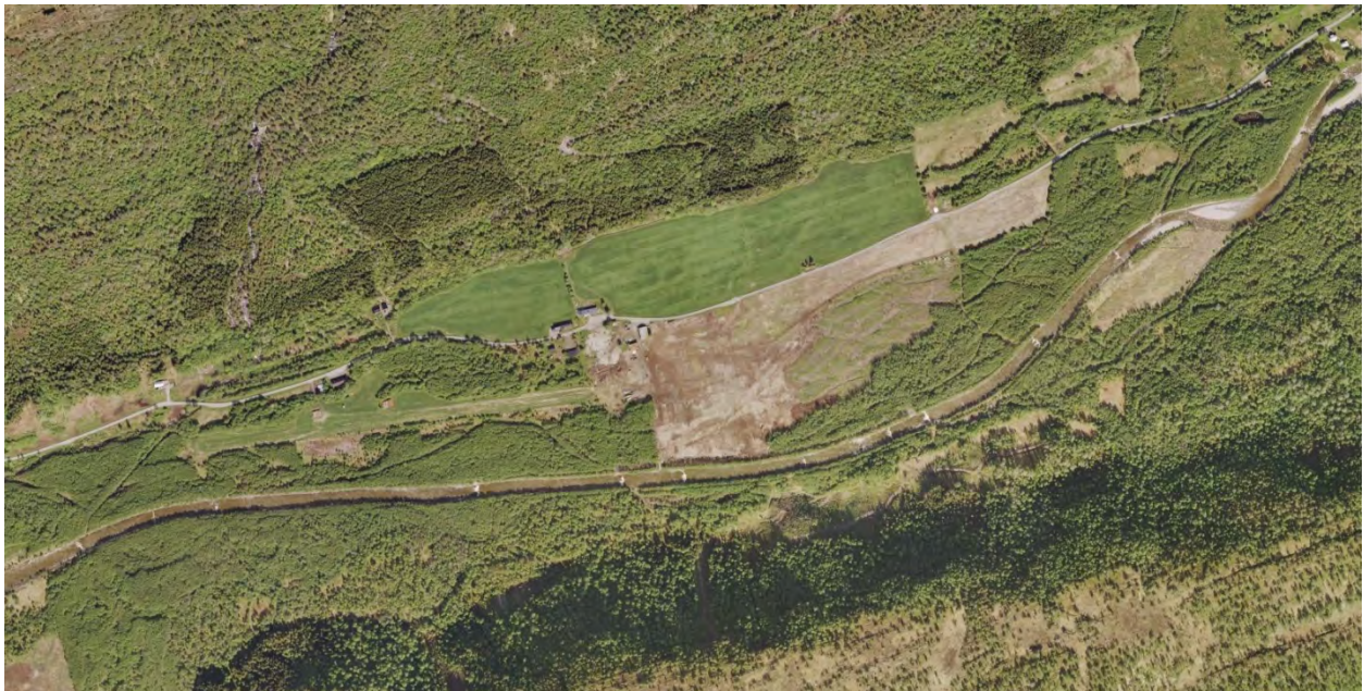
Figur 18: Endring i Bævrå elveleie ovenfor Svorka kraftstasjon. Øverste bilde er tatt i 1963 og bildet under 2017. Ifølge undersøkelser i vassdraget er elveleiet oppstrøms Svorka kraftverk overdimensjonert for elvas normale vannføring etter regulering, og elvesenga er i lange partier flat og mangler djupål. Spesielt på
