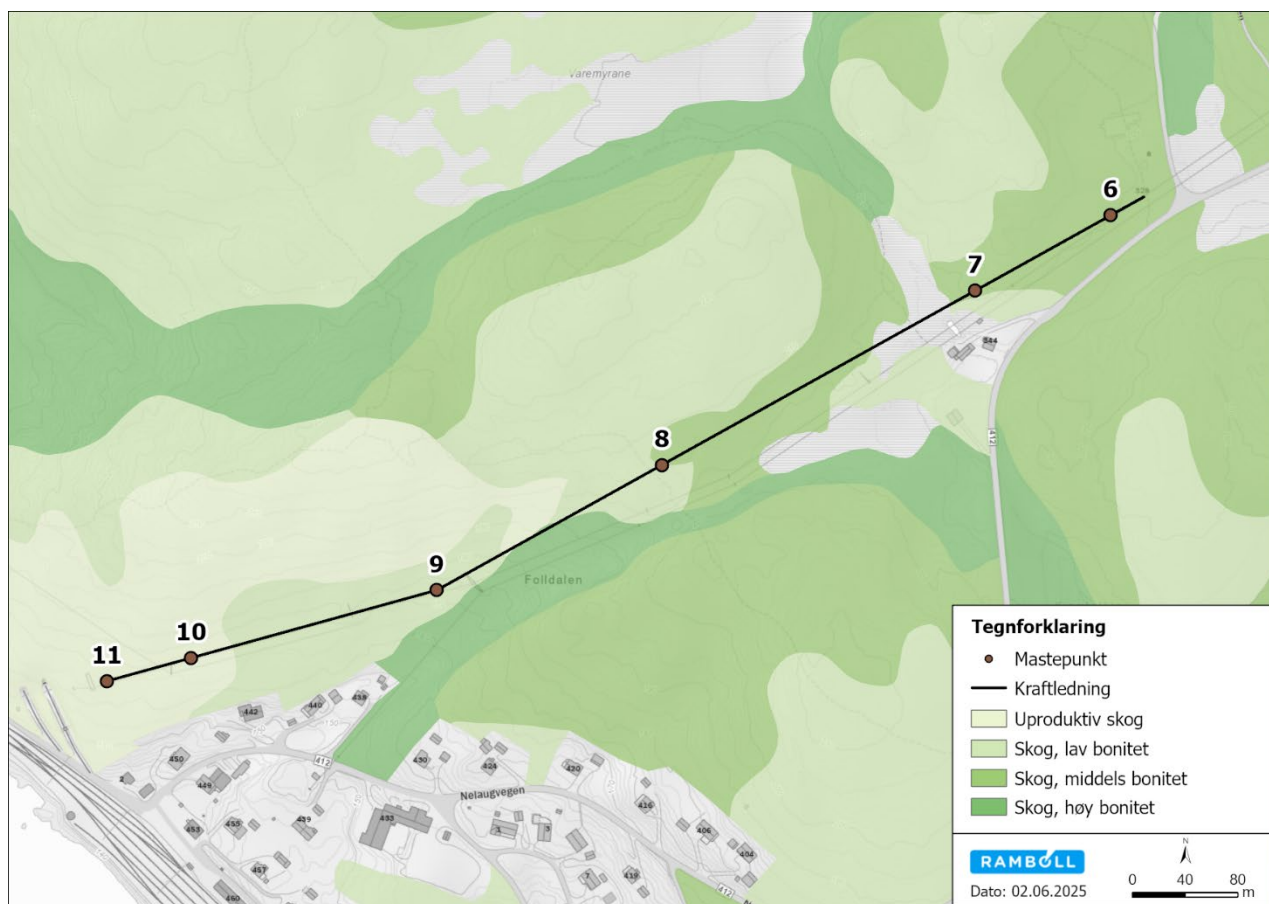
Figur 2 Viser de ulike skogsbonitene ny trase mellom Nelaug trafostasjon og omformerstasjon. Den viser at den krysser fra lav til høy bonitet innenfor den 900 meter lange trasen.
