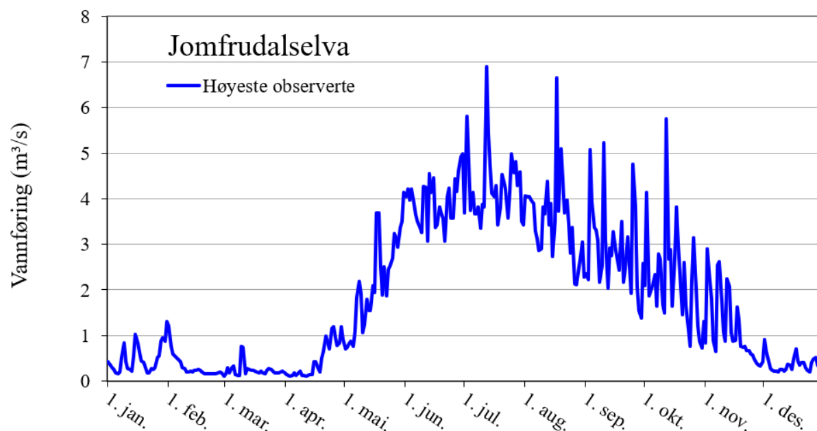
Figur 3. Plott som viser beregnede høyeste beregnede vannføring for hver dato gjennom året (døgndata) for tilrenning til Jomfrudalselva. Dette representerer ikke ett spesielt år, og for øvrig samme forutsetninger som i figur 2 ovenfor.
