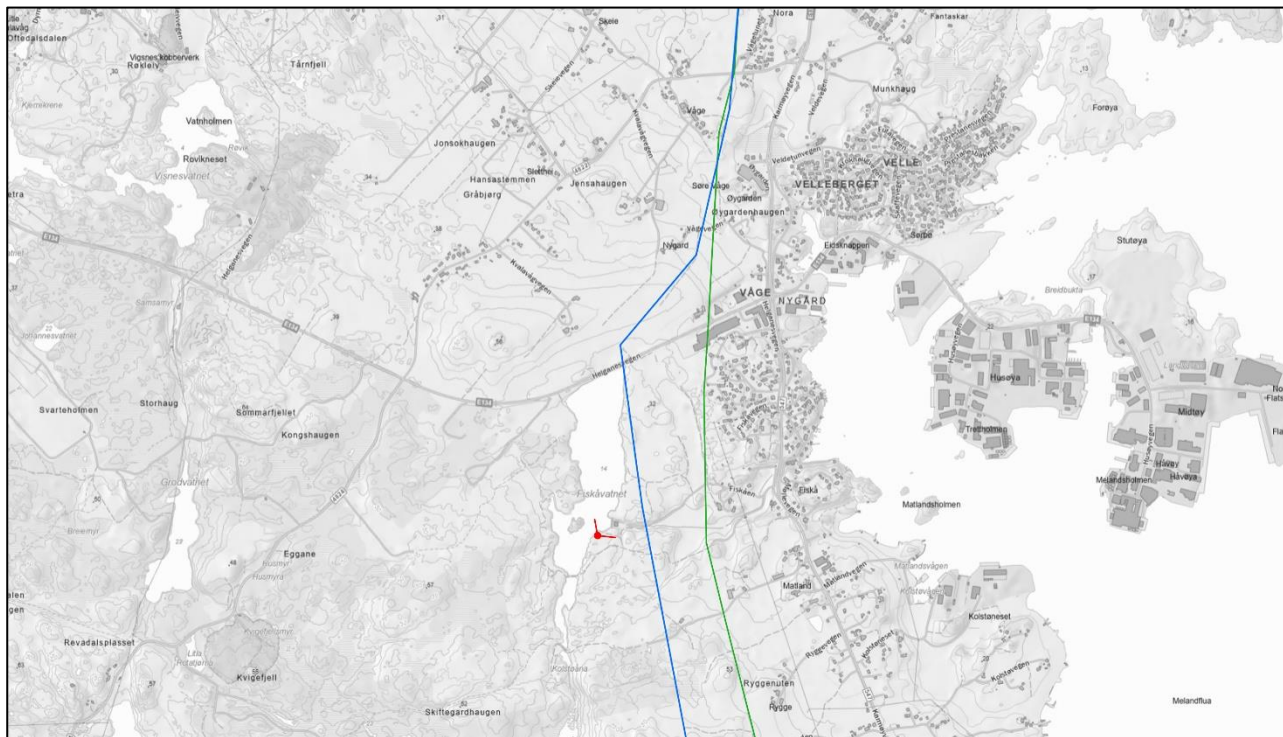
Figur 2-20. Traséalternativ 1b gjennom delområde 2 (markert i blå). Dagens 66 kV-ledning som rives er markert i grønn. Fotostandpunkt for strekskisse ved Fiskåvatnet er markert med rødt.
