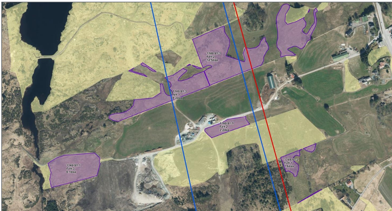
Figur 2-68: Spredareal (lilla polygoner), med annet inmarksbeite (gule polygoner). Eksisterende 66 kV ledning i rødt, alternative 132 kV traséer i blått skissert.
