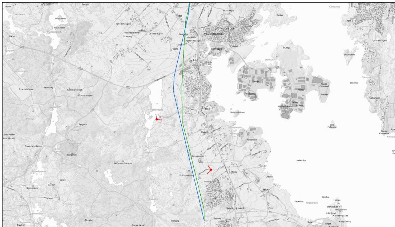
Figur 2-23. Traséalternativ 1c gjennom delområde 2 (markert i blå). Dagens 66 kV-ledning som rives er markert i grønn. Fotostandpunkt for strekskisser ved Fiskåvatnet og Rygge gård er markert med rødt.
