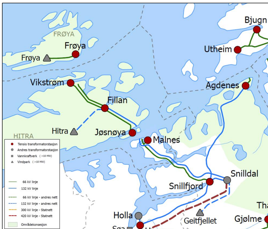
Figur 19. Kart over nettstrukturen under Snilldal transmisjonsnettstasjon.
